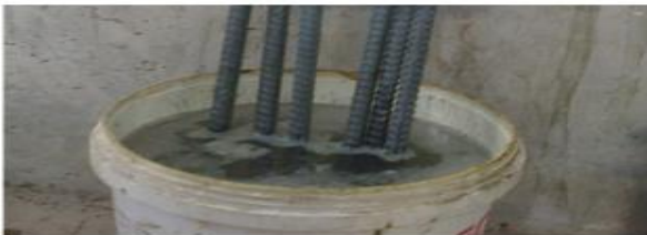
Hình 3.1. Ngâm nước muối tạo gỉ thép
